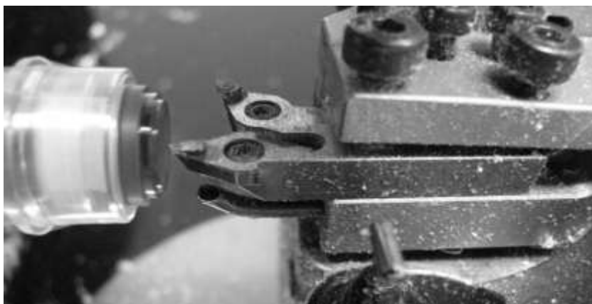
Slika 9. Obrada sočiva struganjem [7]
