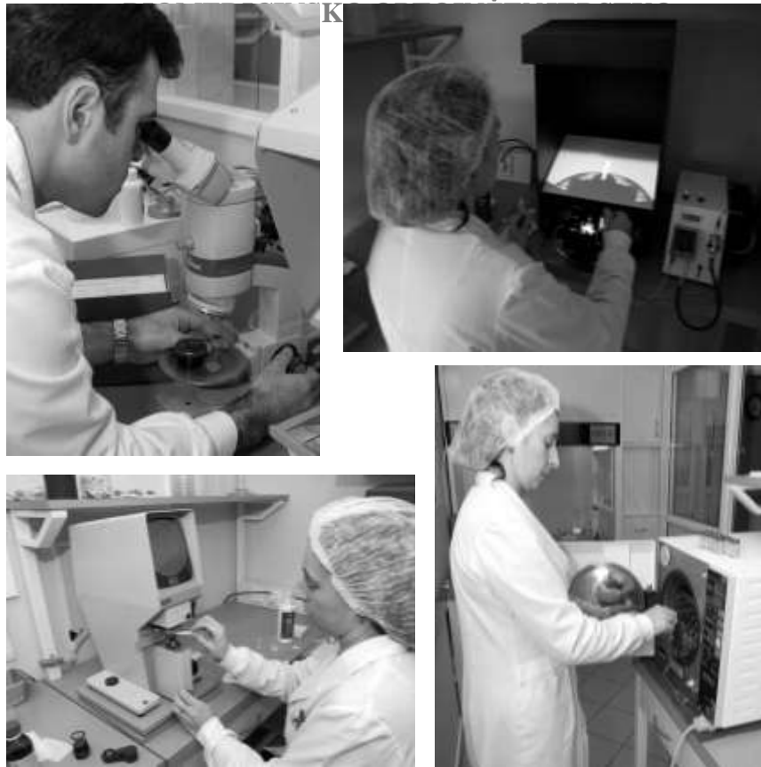
Slika 7. Radijuskop (gore levo), fokometar (dole levo), šedograf (gore desno), parna sterilizacija sočiva (dole desno) [7]
