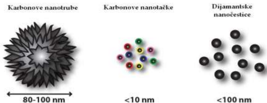
Slika 5. Sferni i netubularni materijali na bazi ugljenika. Agregati CNHs nalik daliji
